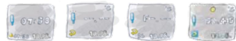
Messsymbol leuchtet Wecker leuchtet    Messsymbol blinkt    Anzeige «Fieber» alterniert mit dem Temperaturwert    «Return» leuchtet
